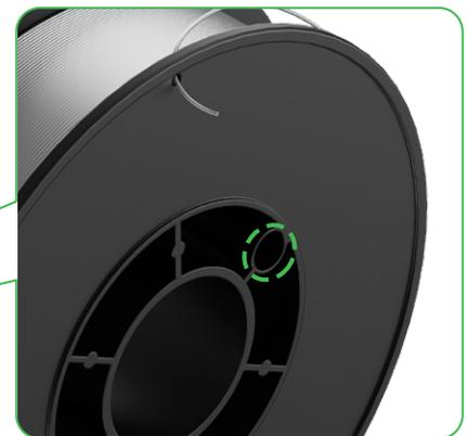
💡 焊絲捲軸上的圓孔應對准送絲機轉盤上的插銷。
